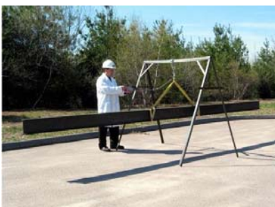
1インチ角の接着で260kgの鉄骨を支持
