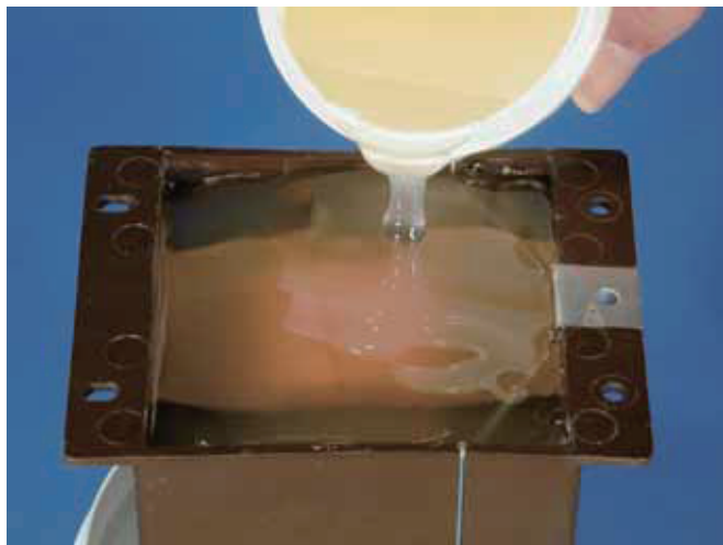
熱サイクルの激しいトランスの内部封止
