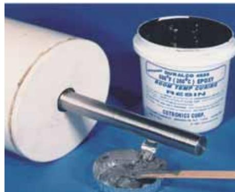
SUS316製のシャフトとセラミックピストンとの接着
