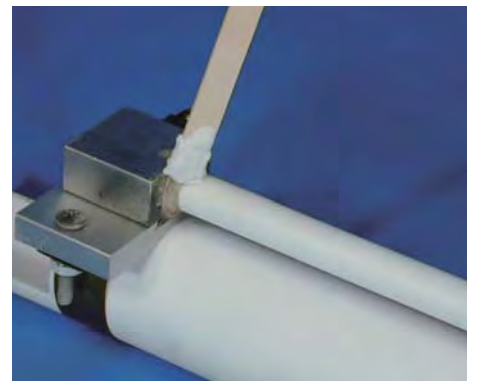
1,700℃以上になるセラミック部材へのセンサー固定
