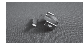
加工方法: 抜き+曲げ+Ni+Auストライプメッキ材 板厚: 0.15mm 材質: C17530-EHT
