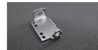
加工方法: 抜き+曲げ 板厚: 0.6mm 材質: SUS-304-1/2H
