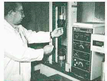
引張試験機によるワイヤテスト
